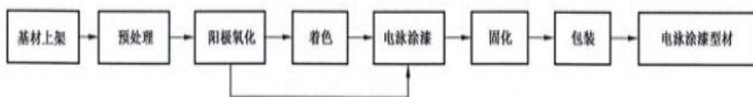
图 3.1-5 铝型材电泳涂漆工艺流程图
